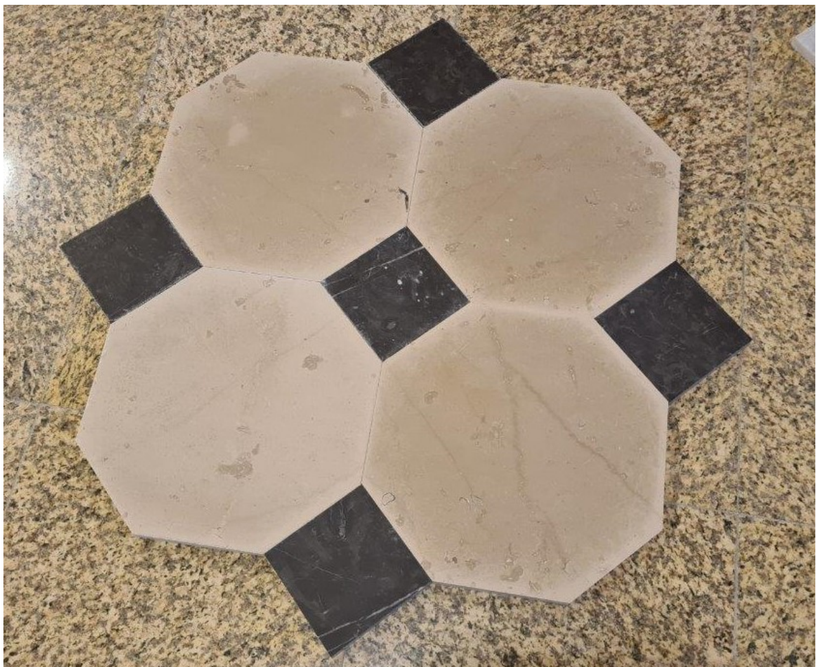
Fot. 2 – proj. układ płytek marmurowych- marmur Morawica i Bolechowice
